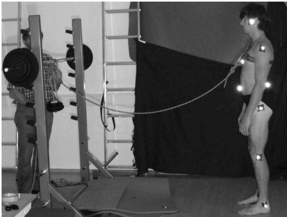
**Abb. 56 Stabilitätstest: Versuchsanordnung (Zugrichtung nach „vor“)**
